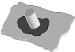
Entfernen Sie bei lackierten Teilen vor dem Anschluss an der Verbindungsstelle die Lackierung.
