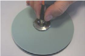
**10** Führen Sie den Stecker in die Poliervorrichtung ein und schleifen Sie die Steckerstirnfläche mit 8-förmigen Schleifbewegungen, bis kein Klebstoff mehr auf der Steckerstirnfläche sichtbar ist.
