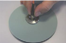
**12** Führen Sie den Stecker in die Poliervorrichtung ein und polieren Sie die Steckerstirnfläche mit 8-förmigen Schleifbewegungen.
