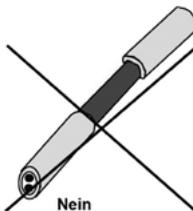
Stellen Sie die Verbindung zwischen der Schirmung und dem Potenzialausgleich nur über das Schirmungsgeflecht her. PROFINET-Kabel haben zusätzlich einen Folienschirm. Dieser darf nicht für die Verbindung genutzt werden. Er ist meist zur besseren Stabilität einseitig kunststoffbeschichtet. Die Kunststoffbeschichtung wirkt isolierend.
